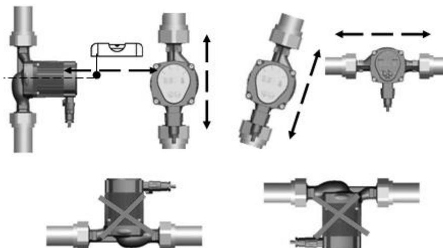
**Внимание!** Стрелки на корпусе насоса указывают направление протекания потока перекачиваемой жидкости.
