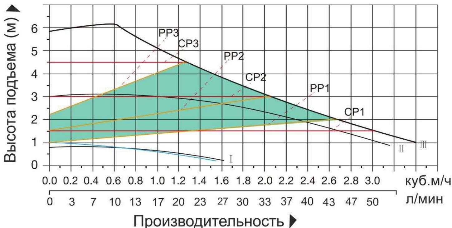
**CP1 (нижняя красная линия)** – кривая регулирования с самым низким постоянным значением высоты подъема. Рабочая точка насоса будет находиться на кривой постоянной высоты подъема, независимо от расхода теплоносителя в системе. Высота подъема остается постоянной, независимо от расхода теплоносителя.
