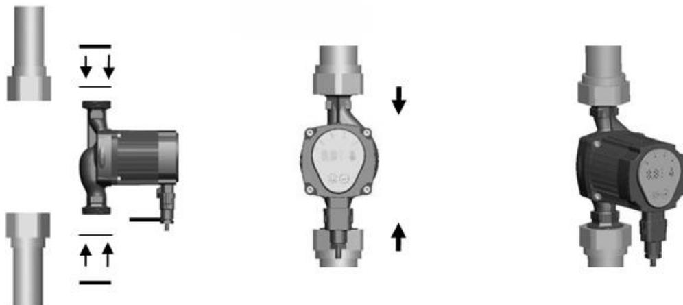
3. Насос необходимо устанавливать таким образом, чтобы вал мотора располагался горизонтально.
