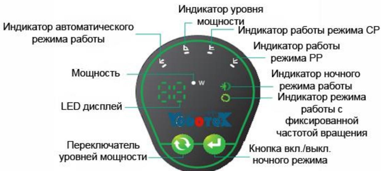
При подключении насоса к источнику питания по умолчанию насос переходит в автоматический режим работы. В данном режиме производительность насоса контролируется автоматически. Переключение режимов производится последовательным нажатием клавиши
