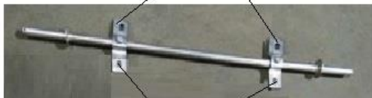
Крепежные отверстия на оси
