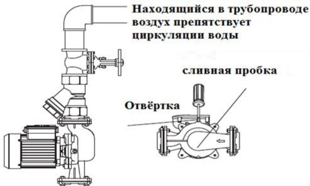
17. Наличие воздуха в трубопроводе или насосе препятствует нормальной циркуляции воды и снижает параметры насоса. Полностью удалите воздух из системы для ее эффективной работы.
