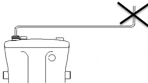
3. Все изгибы трубопровода должны быть плавными, каждый изгиб уменьшает допустимую длину горизонтального трубопровода на 1 метр.
