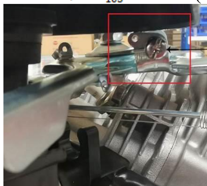
Винт регулировки диапазона холостого хода
