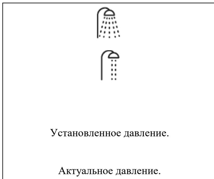
1. Нажмите кнопку включения мини-станции. Изделие запустится с задержкой 3 секунды, а на дисплее загорятся следующие индикаторы: зеленая кнопка включения, логотип «LEO», кнопки «+» и «-», цифровая индикация, обозначающая фактическое давление, и цифровая индикация, обозначающая установленное давление (по умолчанию установлено значение 20м) (смотрите рисунок ниже).
