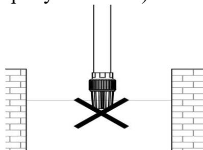
6. Крепежные соединения входного трубопровода должны быть герметичны, трубопровод должен иметь как можно меньше соединений коленчатого типа! При наличии более двух соединений коленчатого типа всасывание жидкости будет затруднено или невозможно. **Внимание!** Каждое коленчатое соединение во входном или выходном трубопроводе уменьшает высоту подъема и высоту всасывания мини-станции примерно на 1 м.
