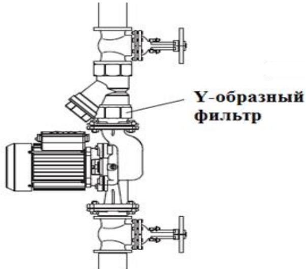
**Внимание!** Не допускайте соприкосновения кабеля питания насоса с трубопроводом и корпусом мотора. Подключайте насос к розетке с заземлением или выполните надлежащее его заземление, следуя указаниям, приведенным ниже.
