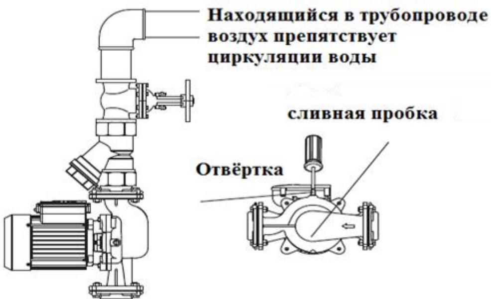
17. Наличие воздуха в трубопроводе или насосе препятствует нормальной циркуляции воды и снижает параметры насоса. Полностью удаляйте воздух из системы для ее эффективной работы.
