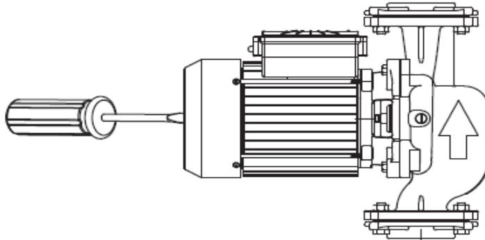
5. Ежемесячно проверяйте состояние сетки фильтра и своевременно очищайте её. При этом необходимо закрыть клапаны на входном и выходном трубопроводах и убедиться в том, что из насоса полностью слита вода. Остерегайтесь ожогов! Признаками загрязненности фильтра являются: падение производительности, повышенный шум, срабатывание термозащиты (только для однофазных насосов).
